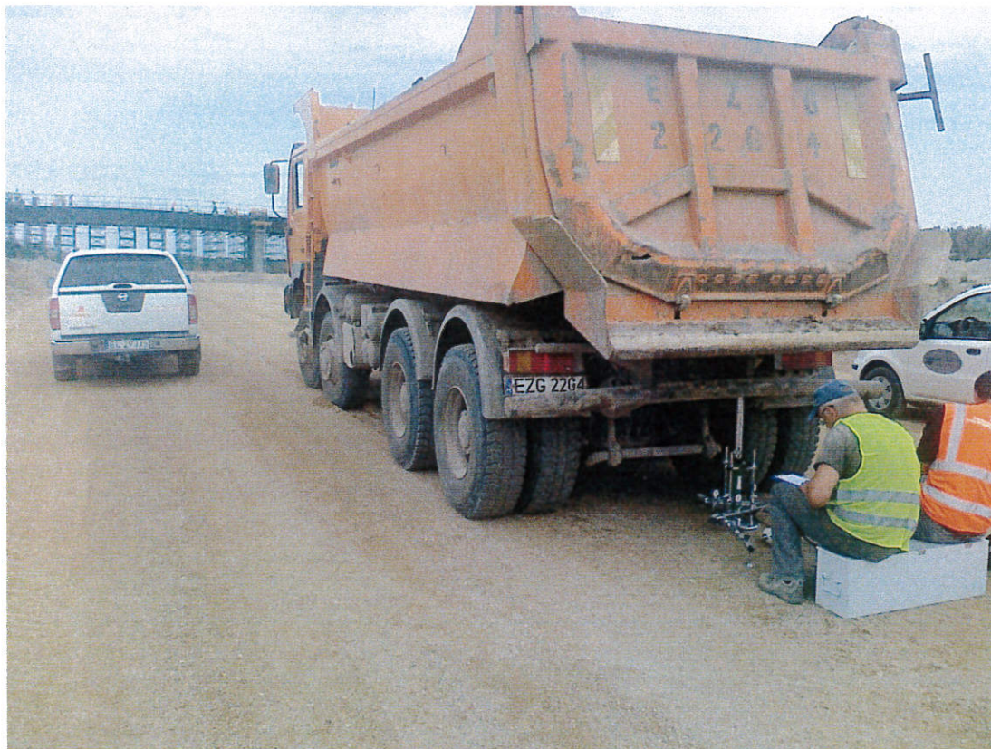
Fot. 2 Badania kontrolne VSS 262+000 05.09.2011
